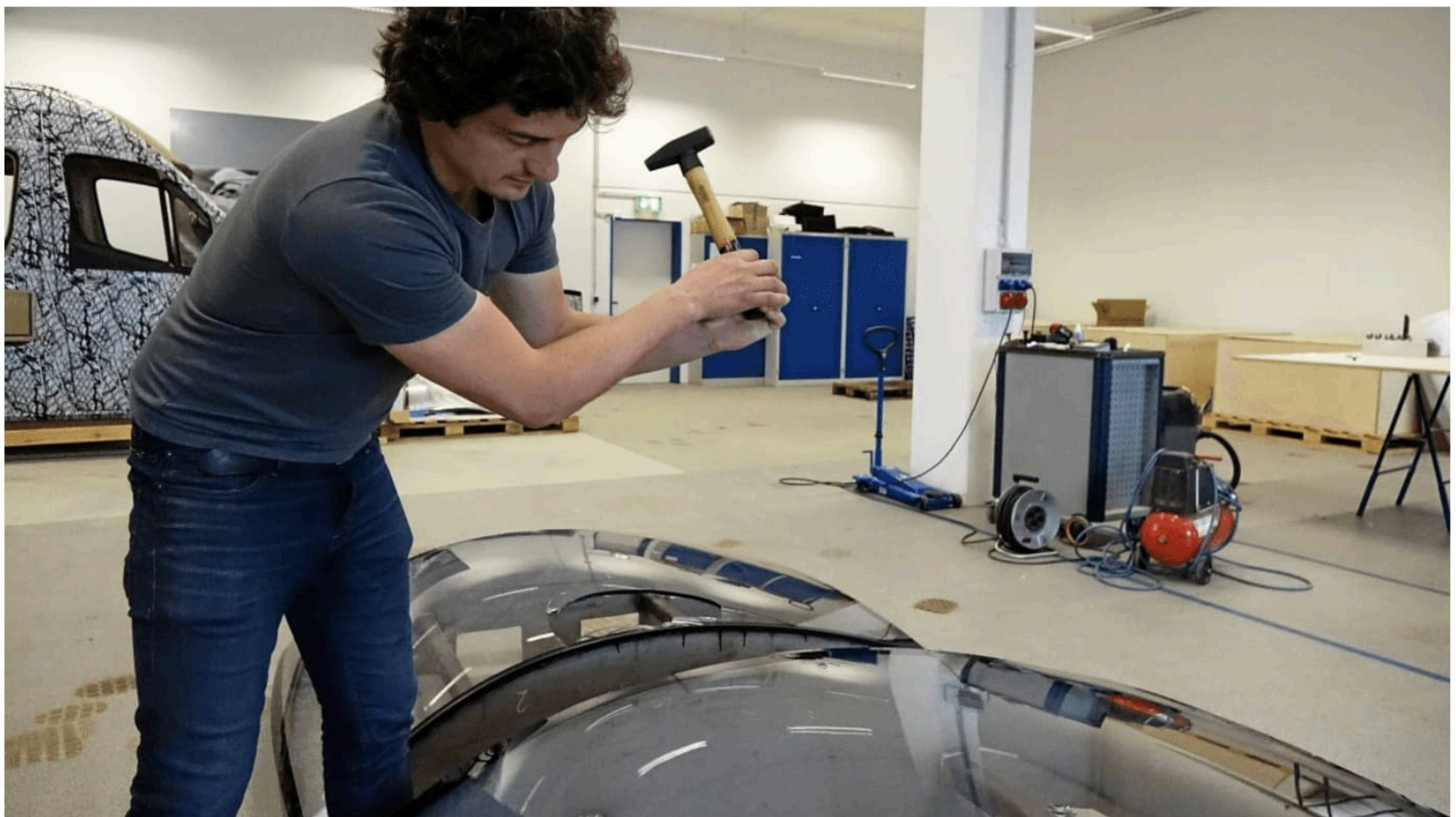
Verfahrensmechaniker Matthias Tretter demonstriert mit dem Hammer die Schlagfestigkeit der Kunststoffscheibe.
