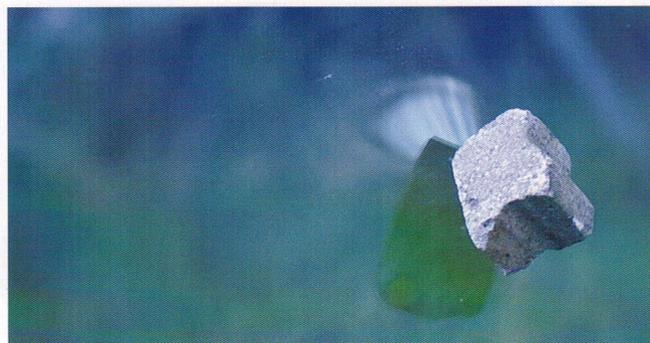
Abb. 2: Bewurf einer KASIGLAS® Sicherheitsscheibe - Abprall des Pflastersteines.
